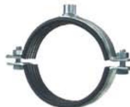
MP-MXI Abraçadeira para cargas pesadas com isolamento EPDM Diâmetros de 64 a 508mm Conexão dupla M10/M12 e M16
