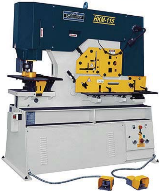
Puncionadoras hidráulicas de 45 ton; 65 ton; 115 ton
