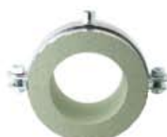
MI-CF Abraçadeira para refrigeração Diâmetros de 21 a 273mm Isolamento de poliuretano com 25, 30, 40 ou 50 mm Conexão M8/10 e M16
