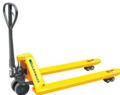
Mod. BFS Capacidade 2,5/3,5 Ton. Garfos de 550x1150 mm 4 rodízios em poliuretano, 2 rodas em nylon/poliuretano/borracha
