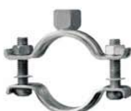
MP-M Abraçadeira para cargas pesadas sem isolamento Diâmetros de 57 a 224mm Conexão dupla M10/M12 e M16
