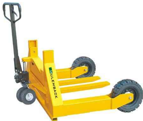
Mod. T/T Todo-Terreno Capacidade 1,5 Ton. Garfos de 550x1150 mm Porta paletes Todo-terreno. Rodas pneumáticas
