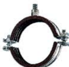
MP-MI Abraçadeira para cargas pesadas com isolamento EPDM Diâmetros de 15 a 250mm Conexão M10/M12 e M16
