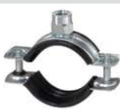
MP-HI Abraçadeira residencial com isolamento EPDM Diâmetros de 8 a 172mm Conexão M8/M10
